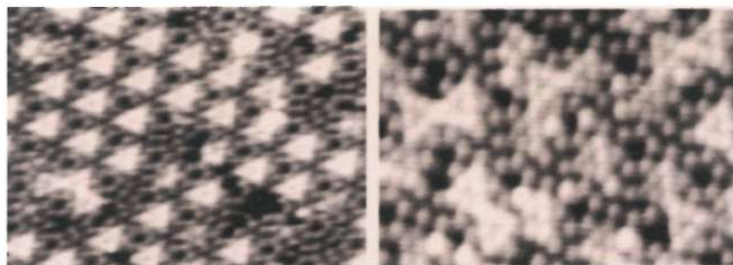
Рис. 4. Образование кластеров индия на поверхности Si (111) в процессе осаждения
