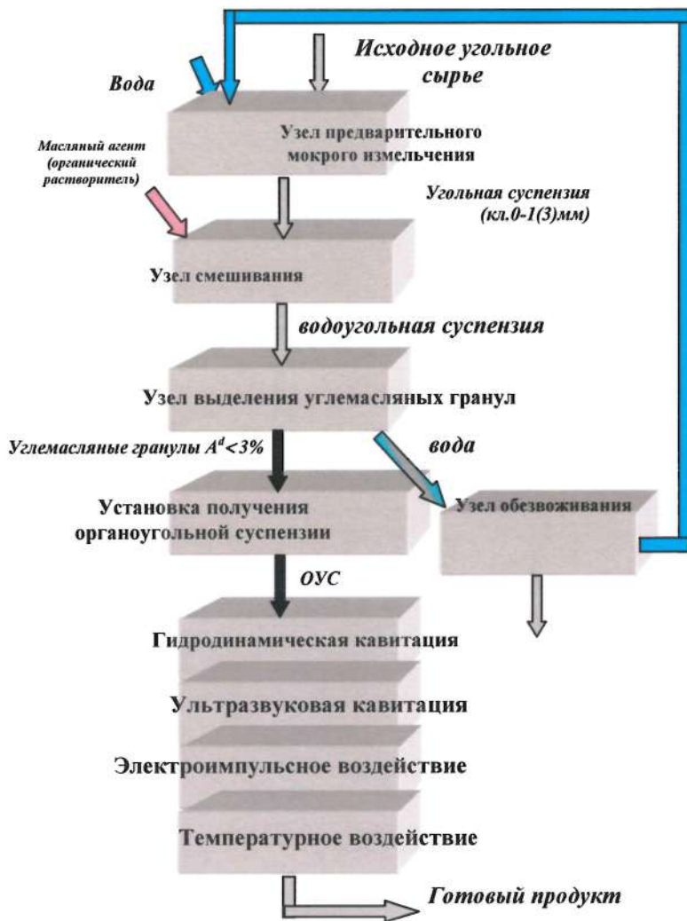
Рис. 1. Технологический процесс способа деструкции органических соединений угольного сырья в органическом растворителе
