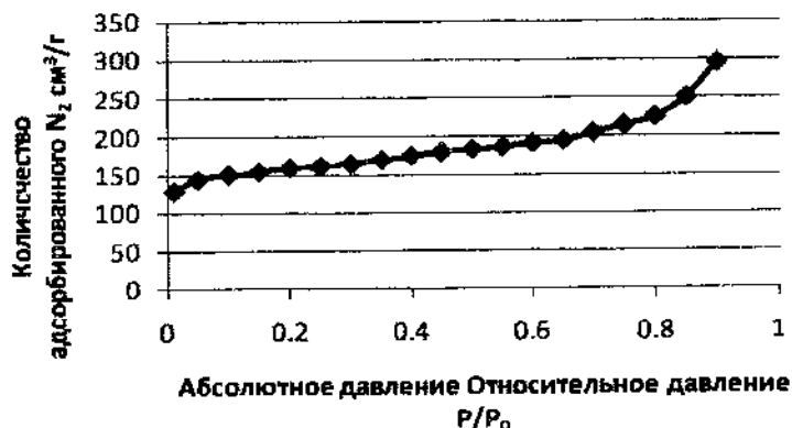
Рис. 5. Типичная изотерма карбонизированного РФА ксерогеля с катализатором \text{NaOH} (температура карбонизации 850^\circ\text{C} , S_{\text{ВЕТ}} = 700\text{--}800 \text{ м}^2/\text{г} )
