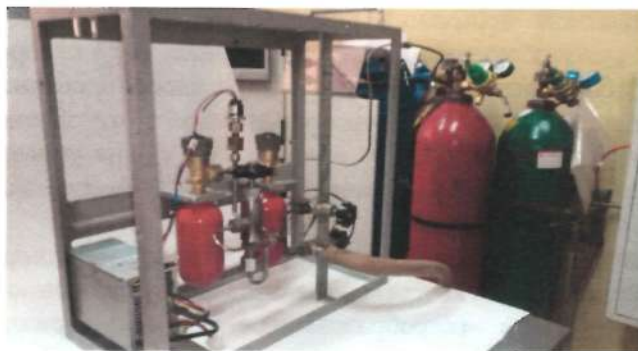
Рис. 6. Общий вид стенда для испытания сорбционной способности углеродных ксерогелей.
