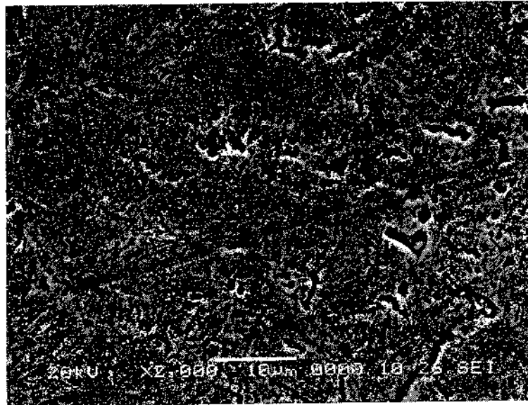
Рис. 3. Изображение поверхности пленок Fe – C_{60} , полученное растровой электронной микроскопией
