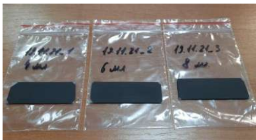
Рис. 1. Образцы СВМПЭ, после обработки в воздушной плазме (100 Вт, 50 \text{ см}^3/\text{мин} , 15 мин) и нанесения слоя оксида графена толщиной (слева направо) 1,6 мкм; 2,2 мкм и 3,6 мкм
