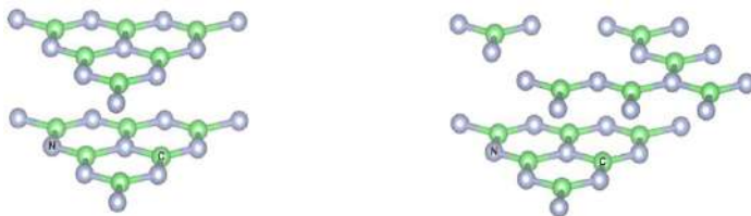
Рис. 1. Кристаллическая структура двухслойного g\text{-C}_3\text{N}_4 без смещения (слева) и со смещением (справа) слоев
