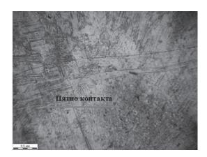
Рис. 3. Поверхность образца двухслойных оксидов Zr + Cu с пленкой после трибологических испытаний в смазке
