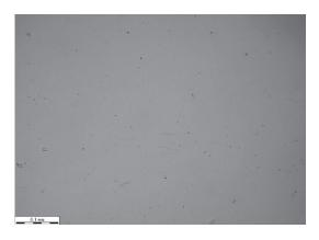
Рис. 3. Поверхности кварцевых образцов с пленкой Zr + Li + Nd (6 : 3 : 1) на полированной подложке
