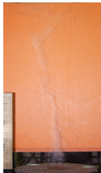
Рисунок 7. Фотография теплового смерча при частоте вращения основания \omega=1,3 Гц
