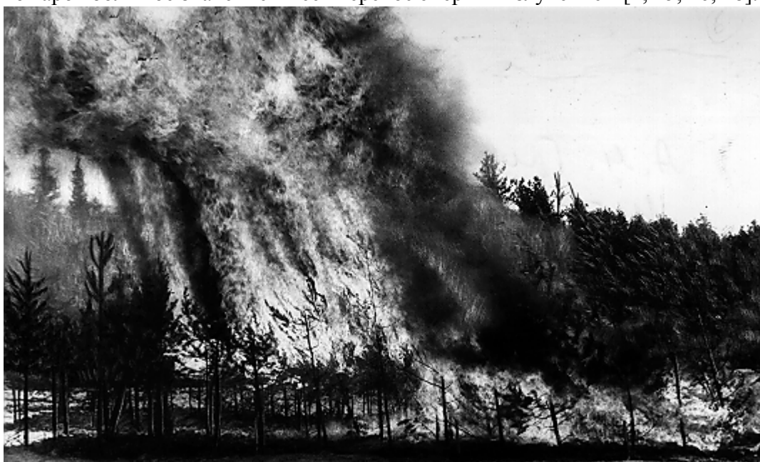
Рис. 6. Фронт повального верхового пожара, распространяющегося по лесной полосе из соснового молодняка. Ширина полосы 3 м., длина 10 м, высота соснового древостоя 3,5 м, напочвенный покров - слой лишайника Cladonia толщиной 0,1 м
