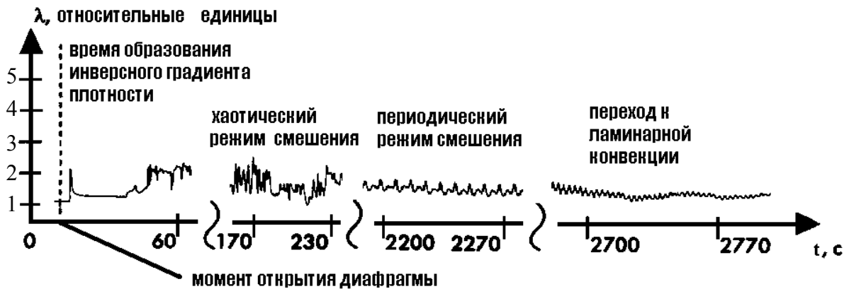
Рис. 3. Изменение теплопроводности смеси со временем, иллюстрирующее смену режимов конвекции
