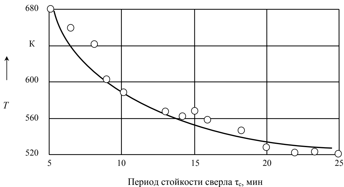
Рис. 5. Взаимозависимость температурного режима глубокого сверления с периодом стойкости сверла. Материал заготовки – сталь 40Х, инструмента – Р18
