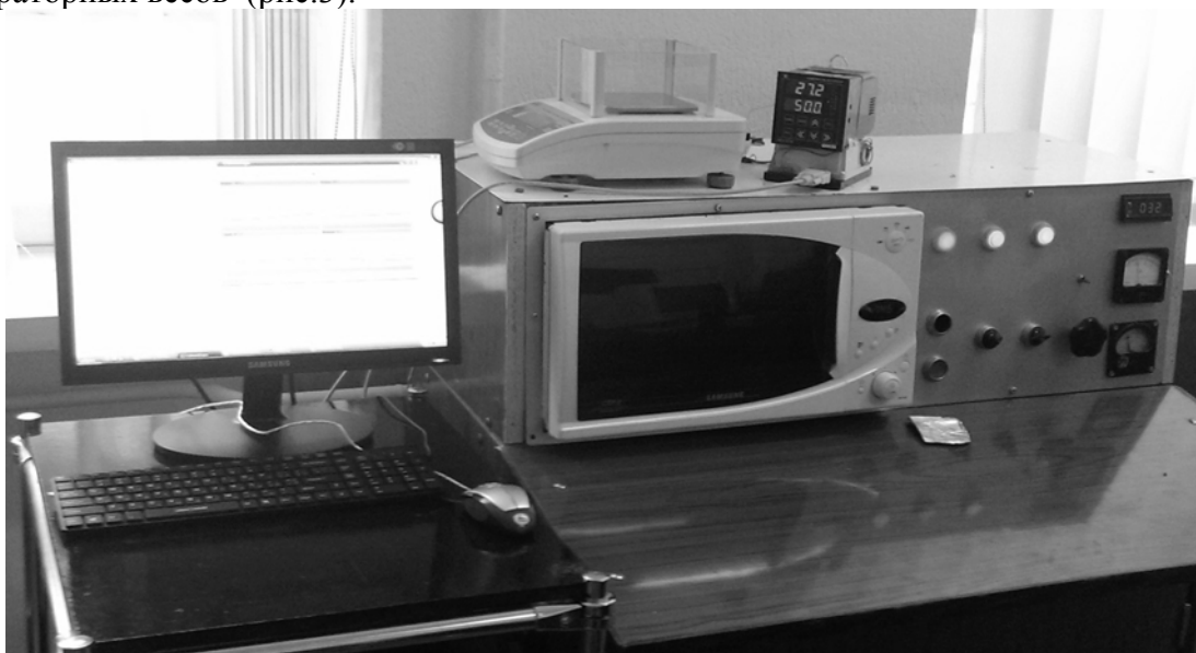
Рис. 3. Стенд для исследования кинетики обезвоживания в электромагнитном поле
